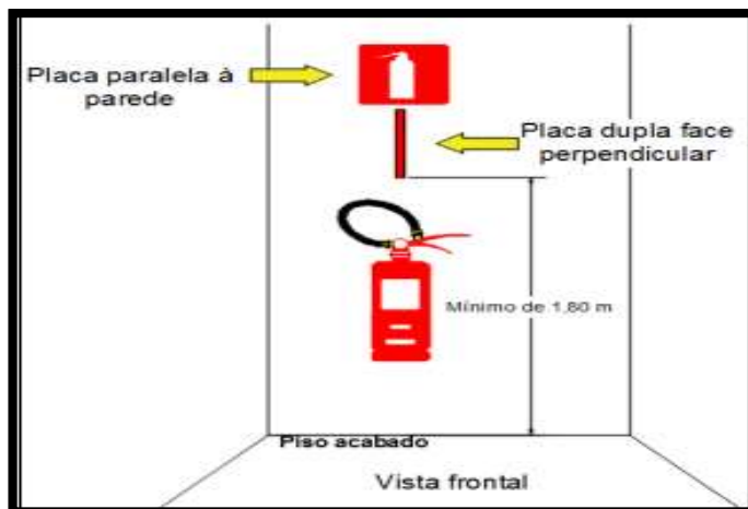
Figura 5 – Placa com indicação extintor deve ser colocada a 1,80 do piso do chão.
