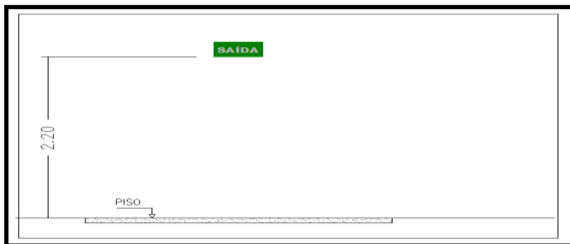
Figura 12 - Instalação da Placa de Sinalização
